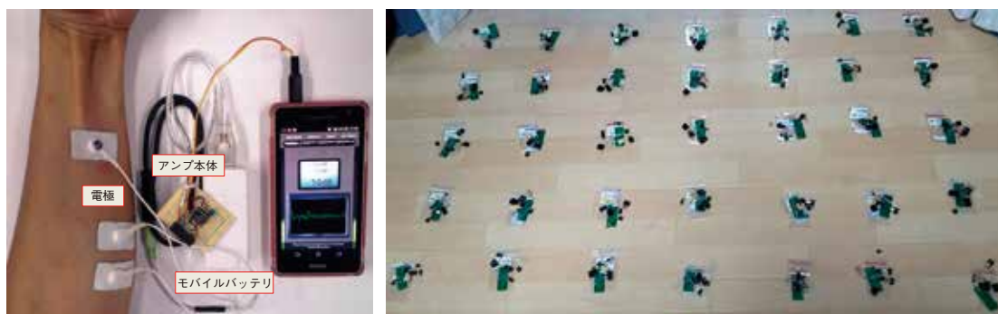
図3 スマホを用いた低コスト EMG-BF 装置と、コロナ禍に送付した EMG-BF 製作キット（筆者 Facebook への2020/4/22 筆者投稿）
